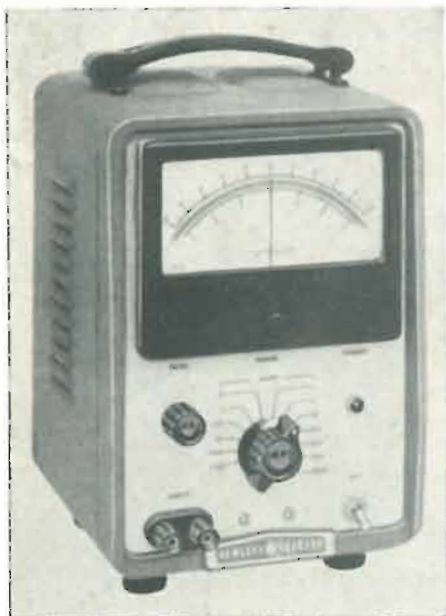
Un nuovo voltmetro c.c. a zero centrale con alta impedenza d'ingresso (10 M \Omega , nella scala di massima sensibilità, e 200 M \Omega nella portata di 300mV e oltre) ed elevata sensibilità (1 mV f.s.) è stato recentemente presentato dalla HEWLETT-PACKARD Co. I terminali d'ingresso del voltmetro sono isolati da massa e consentono il funzionamento fino a 500 V c.c. a 130 V c.a. dal potenziale di massa. È il modello 413A.
