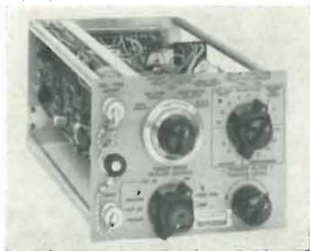
Allo scopo di accrescere la versatilità d'impiego dei vari oscilloscopi costruiti dalla HEWLETT-PACKARD Co. (modelli 160B e 170A) sono stati posti in commercio due nuovi cassette. Il modello 166D sweep delay generator (qui raffigurato) consente di ritardare tra 1 microsecondo e 10 secondi la vobulazione degli oscilloscopi nei quali viene inserito allo scopo di consentire l'esame di segnali complessi. Il secondo cassetto (166C) consente di duplicare, su un registratore X-Y, qualunque forma d'onda che appare sul tubo r.c.
